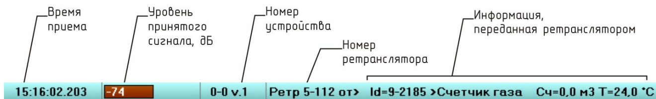
Рисунок 28 - Пример радиопакета ретранслятора, полученного от удаленного устройства
