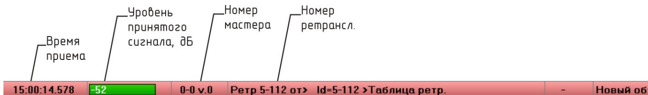
Рисунок 25 - Пример пакета «Таблица ретрансляторов»
